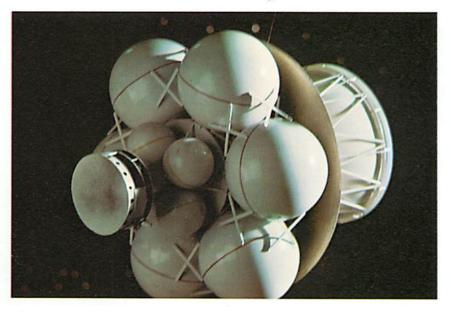
Ein mit Wasserstoff angetriebenes Raumschiff. Das Projekt Daedalus ist ein von der British Interplanetary Society detailliert ausgearbeitetes Konzept für unbemannte Expeditionen zu den Sternen. Eine Serie von kleinen H-Explosionen im Innern der kugelförmigen Tanks soll das Raumschiff mit immenser Geschwindigkeit vorantreiben. Dieses Konzept existiert allerdings vorerst nur auf dem Zeichenbrett, zumindest soweit bekannt ist.
