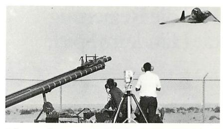
Ein ferngesteuertes Flugzeug vom Typ Teledyne Ryan 262 bei einem Testflug. Es ist nahezu lautlos und mit Radar- und Infrarotanlagen nicht aufzuspüren. Im Rahmen der elektronischen Kriegführung soll es zur Luftaufklärung eingesetzt werden. Unbemannte Flugkörper sind ein neuer wichtiger Sektor der Rüstungsforschung – und vielleicht auch der Ufologie.
